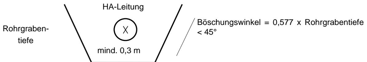
$$\text{Rohrgrabensohle} = \text{Leitungsdimension} + 0,4 \text{ m; mind. } 0,8 \text{ m}$$
